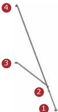
Le stabilisateur télescopique permet d'éviter le renversement des structures d'échafaudage lorsque celles-ci ne peuvent pas être ancrées à un mur, pour des raisons quelconques. Il comporte une base articulée qui permet de mieux s'adapter au terrain, un bras télescopique réglable à l'aide d'une goupille de sécurité et se fixe aux cadres avec 2 colliers. Galvanisé à chaud avec une épaisseur minimale de 75 microns.
