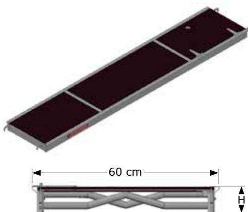
Les planchers sont conformes aux exigences de la norme EN 12811. Cadre en aluminium structural. Surface de travail munie d'un plateau de 9 mm d'épaisseur, hydrofuge et antidérapant.
