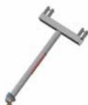
Il permet de donner l'inclinaison souhaitée à l'échelle du premier plancher d'accès, sans besoin d'utiliser des planchers en acier au niveau initial. Fixation au cadre par collier de Ø 48 mm. Galvanisé à chaud avec un épaisseur minimale de 75 microns.
