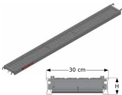
Les planchers sont conformes aux exigences de la norme EN 12811. La section de la surface de travail perforée, très résistante et antidérapante est formée de plis antidérapants. Deux tubes soudés sont prévus pour faciliter leur manipulation. Largeur : 30 cm. Elles sont conformes aux exigences de l'essai de chute 12810-2. Elles sont galvanisées à chaud en continu (Sendzimir).
