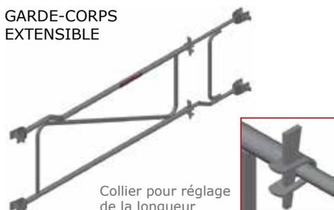
Fabriqués avec un tube rond de diamètres différents, ils améliorent la rigidité du montage grâce à leurs 4 colliers à clavette conique. Le garde-corps extensible offre un grand nombre de longueurs de modulation. La longueur souhaitée est bloquée à l'aide de colliers à clavette. Ils sont galvanisés à chaud avec une épaisseur minimale de 75 microns.
