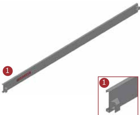
Elles sont destinées à compléter la protection latérale (garde-corps). Elles sont fabriquées en tôle métallique galvanisée à chaud (Sendzimir). Accrochage métallique sur les deux extrémités. Hauteur de protection : 15 cm.
