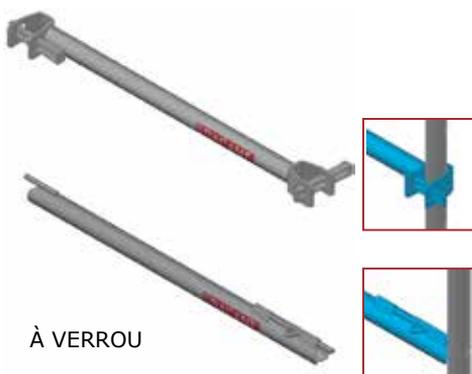
Disponibles sous forme de tubes ronds de Ø 48 mm, ils permettent de placer les planchers à n'importe quelle hauteur sur les cadres. Ils se fixent à l'aide des colliers prévus à cet effet sur les deux extrémités ou à l'aide d'une goupille de type verrou qui s'insère sur les cadres percés (E 2000 B2T). Galvanisé à chaud.
