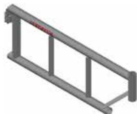
Prévues pour augmenter la surface de travail, elles se fixent au cadre de l'échafaudage à l'aide d'un collier de Ø 48 mm. Elles sont munies d'une douille de 48 mm de diamètre extérieur qui permet de fixer les éléments du système munis d'une goupille. Galvanisé à chaud.
