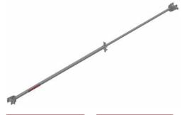
Fabriquée avec un tube extérieur de  $\emptyset$  35 mm et intérieur de  $\emptyset$  30 mm, elle est munie sur les deux extrémités de colliers pour tube de  $\emptyset$  45 mm à bloqueur, qui permettent de l'assembler rapidement sur n'importe quel type de cadre. Fixation de la partie extensible à l'aide du bloqueur pour tube de 30 mm. Galvanisé à chaud avec une épaisseur minimale de 75 microns.
