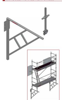
La console murale renforcée est fabriquée en acier galvanisé à chaud. Elle permet de monter l'échafaudage sur un mur ou sur une façade, par le biais d'amarrages chimiques ou mécaniques. Elle est composée d'une plaque renforcée munie de 6 douilles de Ø 20 mm pour le montage.
