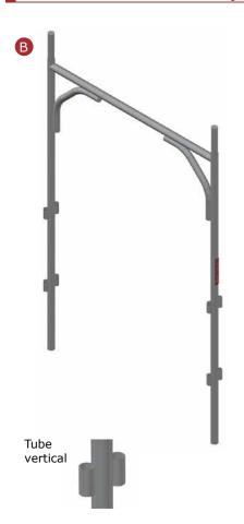
Il permet d'établir une zone de passage pour les piétons dans le cas d'échafaudages installés dans des zones fréquentées. Ses deux angles renforcés lui donnent une bonne rigidité. Il est fabriqué avec un tube de  $\emptyset$  45 x 2 mm d'épaisseur. Connexion entre cadres contigus, via une connexion de type B.
