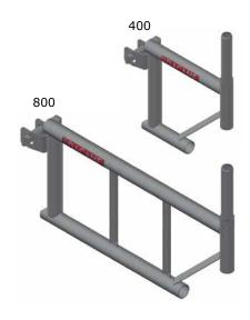
Destinés à agrandir la surface de travail, ils se fixent au cadre de l'échafaudage à l'aide d'un collier à clavette de Ø 45 mm. Ils sont munis d'une goupille d'accouplement qui permet le montage sur l'extrémité des montants ou des cadres d'échafaudage.
