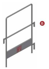
Fabriqué avec un tube  $\emptyset$  20 mm, il est muni d'une connexion de type B, et se monte rapidement puisqu'une de ses extrémités est munie d'un basculeur. Il peut être monté à partir du niveau inférieur, en garantissant la sécurité pendant le montage. Il est muni d'une plinthe métallique. Il est galvanisé à chaud avec une épaisseur minimale de 75 microns.
