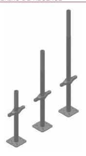
Fabriqués en acier zingué. Ils transmettent au sol les charges des cadres de l'échafaudage. La plaque d'appui renforcée a une épaisseur de 5 mm et une surface de 120x120 mm. Tige filetée de  $\emptyset$  36 mm, disponible en différentes longueurs.
