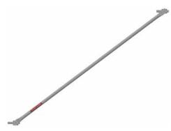
Fabriquées avec un tube de  $\emptyset$  40 mm, elles sont munies de colliers tournants de  $\emptyset$  45 mm sur leurs deux extrémités. Leur rôle est de stabiliser les plans verticaux formés par les montants des cadres.
