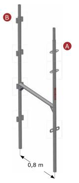
Il s'agit des éléments du système destinés à supporter le poids de l'échafaudage. Ils sont fabriqués avec un tube de  $\emptyset$  45 x 2 mm d'épaisseur. Partie supérieure équipée d'un centreur d'accouplement sur le tube de  $\emptyset$  38 mm. Traverse horizontale renforcée aux angles. Largeur 0,8 m. La gamme est équipée de deux types de connexions (type A, type B), ce qui permet de modifier les différents types de garde-corps.
