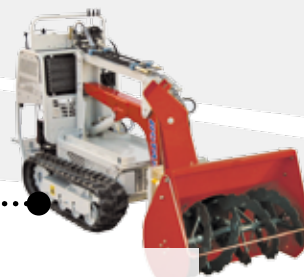
Turbine à neige
