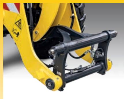
Attache rapide à commande électrique pour un changement d'accessoire rapide et facile
